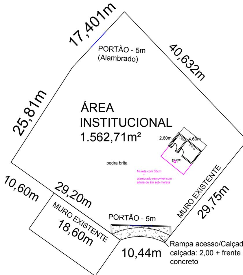
Parte onde não possui o muro existente, será realizado uma mureta com h: 30cm + altura do alambrado de pelo menos 2m
